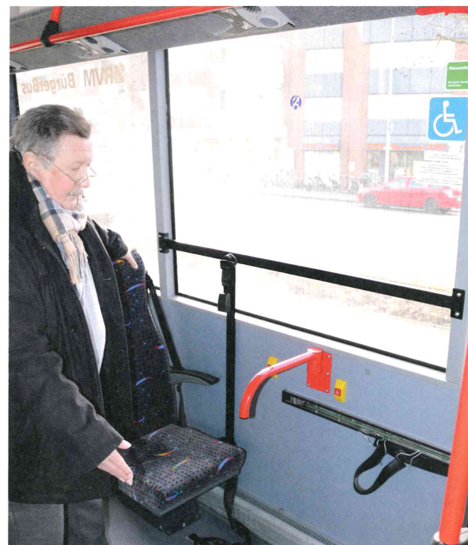
Gurte und ausreichend Platz sorgen für ein sicheres Abstellen von Rollstuhl, Rollator oder Kinderwagen im neuen Niederflur-BürgerBus BB1 Emsdetten-Saerbeck, wie Vorsitzender Karl-Heinz Weßling zeigt.
